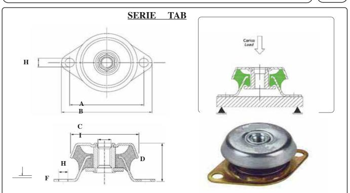
Supporti caratterizzati da un disegno razionale e da facilità di assemblaggio, sono corredati di controtampone integrale di sicurezza essenziale in molte applicazioni dinamiche, marine e anti-sismiche. L'elastomero lavorando in taglio e compressione permette ampie deflessioni statiche, basse frequenze proprie e grandi isolamenti indotti.
